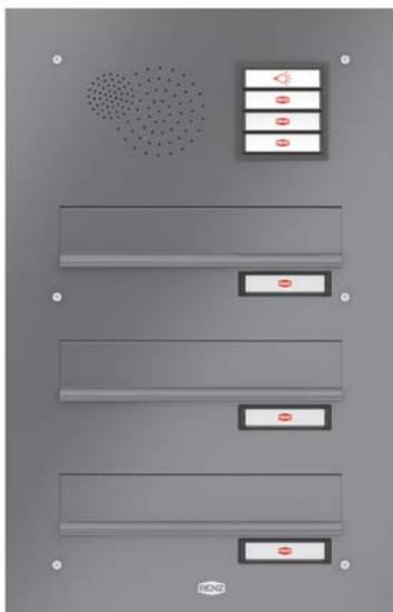
Elegante flache Frontplatte mit nur 2 bzw. 2,5 mm Dicke. Verschraubung der Front mit den Kästen mittels Kunststoff-ecken, auch ohne Frontüberstand verbaubar. Auf Wunsch mit RS1001-Abschlussrahmen und integriertem Regenabweiser lieferbar. Erhältlich aus Galvan-Stahl, Aluminium oder Edelstahl V4A. Alternativ aufklappbar lieferbar.
